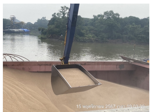
รูปที่ 2.2-18 การตักสินค้าด้วยแบ็คโฮหรือรถเกร็บไฟฟ้า (GRAB) หรือบุงกีของแบ็คโฮ
