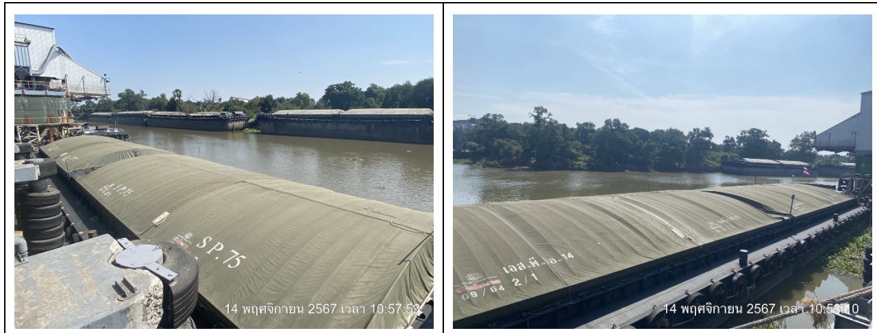
รูปที่ 2.2-11 เรือลำเลียงสินค้าทุกลำจะต้องคลุมผ้าใบระหว่างการขนส่งจากท่าเทียบเรือต้นทางมายังท่าเทียบเรือโครงการและจากท่าเทียบเรือโครงการไปยังท่าเทียบเรือปลายทาง เพื่อป้องกันฝุ่นละออง
